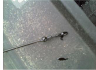
Sollte zu wenig vorhanden sein, dann in  $\frac{1}{2}$  Literschritten nachfüllen ( 4 ). Danach erneut den sauberen Ölstab zum Messen in die Führung stecken und nach dem erneuten herausziehen prüfen.
